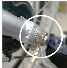
ナット類の締め付け状況は、「ばねワッシャー」等のしまり状態を目視点検
